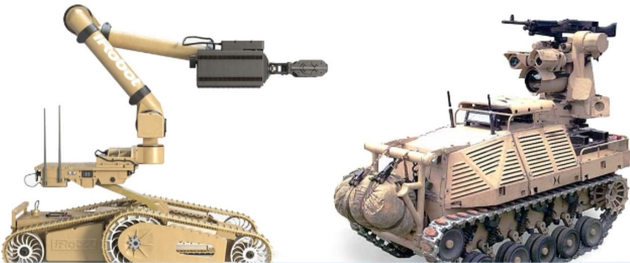
Роботы имеют разную ходовую часть. Легкие и небольшие роботы могут не иметь подвески. Это значительно упрощает конструкцию робота и удешевляет его. Однако, если робот имеет значительную массу, использование подвески является обязательным.
