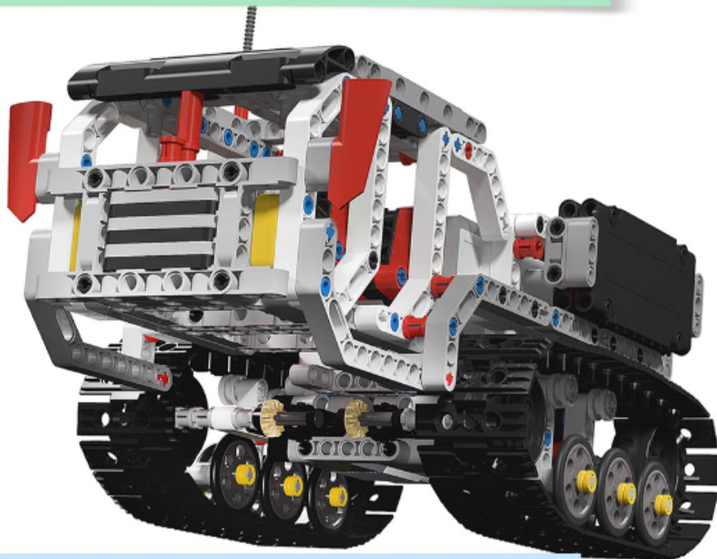
Так как движение происходит на приводных колесах, робот передвигается не плавно. Каждый отдельный трак ложится на поверхность с ударом.
