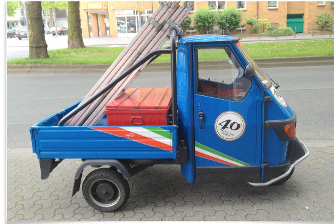
Существует много вариантов реализации трехколесных шасси. Может быть как одно приводное колесо и два рулевых, так и наоборот - два приводных и одно - рулевое. В любом случае такие транспортные средства не приспособлены для движения на высоких скоростях.
