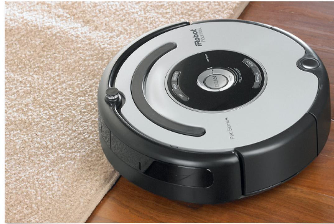
В робототехнике часто используется двухколесное шасси с одной или несколькими дополнительными точками опоры. В таком шасси левое и правое колесо управляются независимо, что делает его очень маневренным. Примером такого робота является робот-пылесос.
