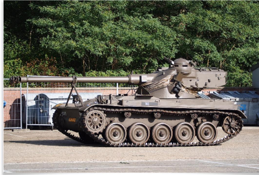
Гусеничное шасси используется в случаях, когда нужно создавать как можно меньшее давление на поверхность. Это актуально для движения по слабым поверхностям - песку или болотистой местности. Для таких тяжелых машин, как, например, танк, использование гусениц является единственным возможным вариантом, поскольку во всех других случаях настолько высокое давление на поверхность приводит к ее разрушению.
