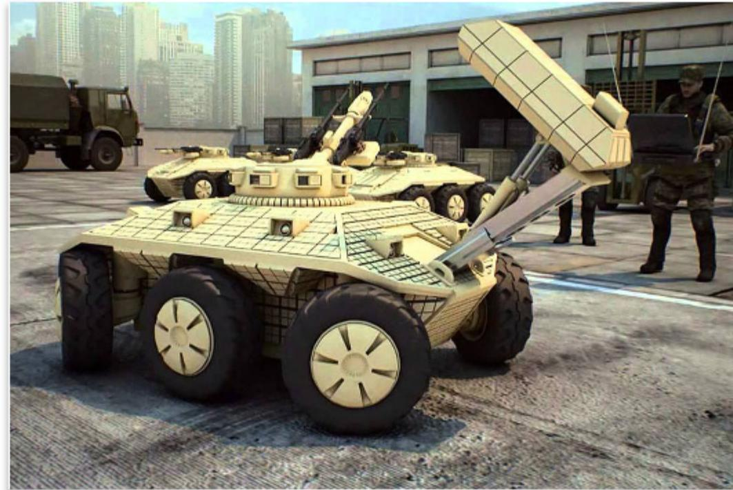
Полноприводное колесное шасси с поворотными колесами имеет хорошую маневренность и не имеет проблем с поворотом на асфальтированной поверхности. Единственный недостаток - это сложность конструкции такого шасси
