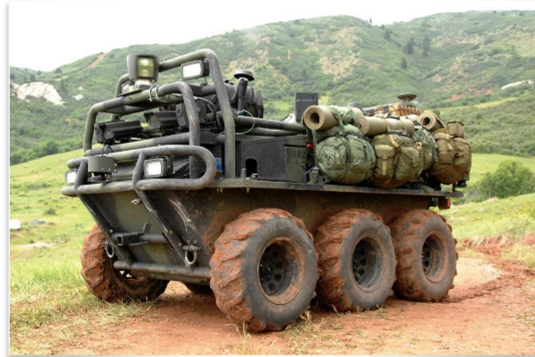
Полноприводное колесное шасси с бортовым поворотом используется для транспортных средств, которые в большинстве случаев движутся по пересеченной местности
