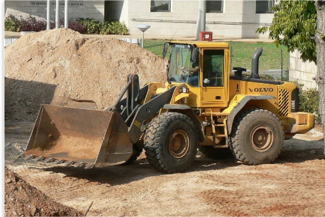
Сочлененное шасси используется при создании полноприводных сверхтяжелых машин. Как правило, такие машины работают на стройке, или в карьерах. Оно очень маневренное, однако, не позволяет достигать высоких скоростей движения
