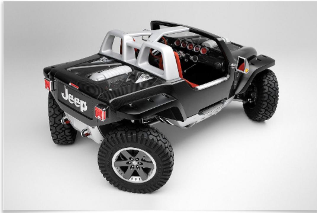
Это вариант полноприводного автомобильного шасси с четырьмя поворотными колесами. Это значительно повышает маневренность, но негативно влияет на надежность, стоимость и долговечность конструкции
